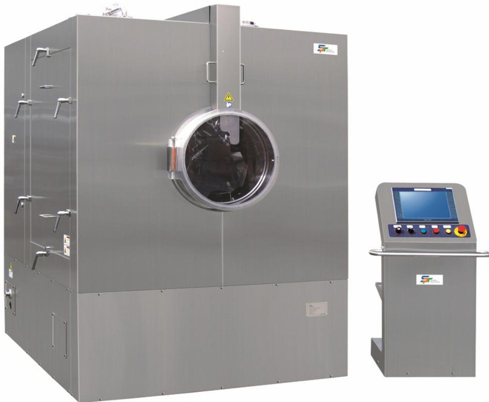
Die Automatische Tablettenbeschichtungsanlagen SPT Serie werden für die Beschichtung von Tabletten verwendet. Die SPT Serie Coating- Anlagen können sowohl zur Film- als auch zur Zuckerbeschichtungen eingesetzt werden. Die Kapazität der SPT Serie reicht von 2 bis 350 kg. Alle produktberührende Teile sind aus SS 316L Stahl hergestellt. Andere aus SS 304.
