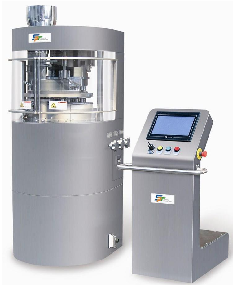
Die Shinhwa Pharma Tech Rotation Tablettenpresse SPT Serien TPL 200, TP 200, TP 400, TP 500 D ist konzipiert für die Herstellung von pharmazeutischen und Nahrungsergänzungsprodukten. Die Technologie der Maschine gewährleistet eine konstante Füllmenge und dosiert den Puder / Granulat in die Matrize und verpresst es zu Tabletten.
